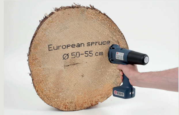
→ Druck auf geschnittenem Holz mit schwarzer Universaltinte (Ethanol); große Abstandsrollen.
