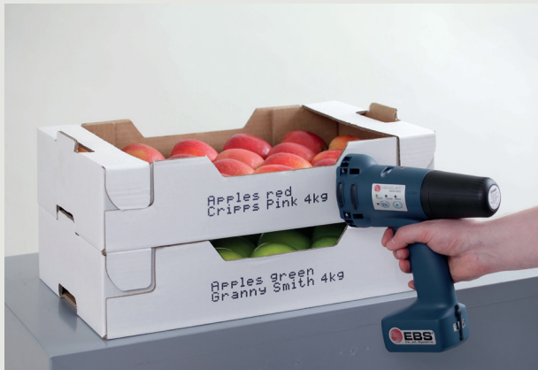
→ Druck auf Karton mit schwarzer Universaltinte (Ethanol).
